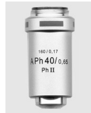
Abbildung 12: Kommerzielles Objektiv eines Lichtmikroskops. Die Objektivvergrößerung beträgt 40. Die Zahl 160 besagt, dass das Objektiv nur für Mikroskope mit einer Tubuslänge von 160 mm verwendet werden kann. Zusätzlich ist noch die numerische Apertur, NA=0,65 und die zu verwendene Deckglasdicke von 0,17 mm angegeben.
