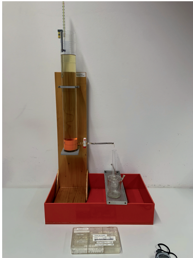
Abbildung 1: Kugelfallviskosimeter und Kapillarviskosimeter
