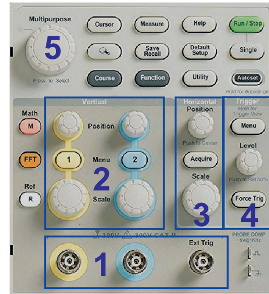
Abbildung 6: Bedienfeld des Oszilloskops TBS 1072B. Die wichtigsten Bedienelemente sind mit einem blauen Rahmen markiert. 1: Eingangsbuchsen 2: Vertikalablenkung, 3: Horizontalablenkung, 4: Trigger, 5: Multifunktionsknopf.
