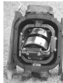
Innenansicht eines Kreiselkompass
