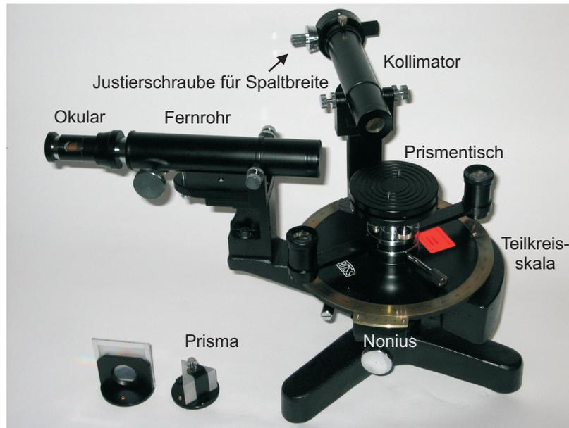
Abbildung 1: Versuchsaufbau.
