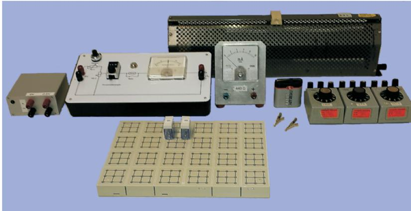
Abbildung 1: Aufbau des Versuchs Strom- und Spannungsmessung.
