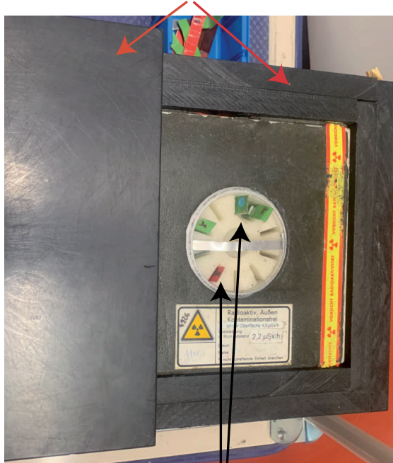
Metalpräparate in der Neutronenquelle zur Aktivierung
