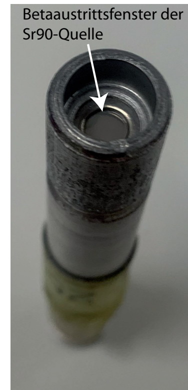
Abbildung 7: Das Betaaustrittsfenster der Sr 90 -Quelle
