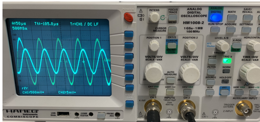
Abbildung 5: Oszilloskop zur Messung der Phasenverschiebung.
