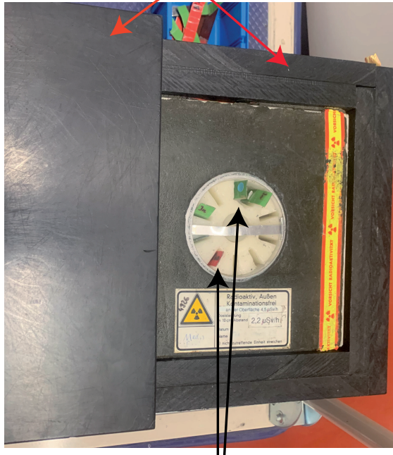
Metalpräparate in der Neutronenquelle zur Aktivierung
