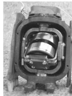
Innenansicht eines Kreiselkompass
