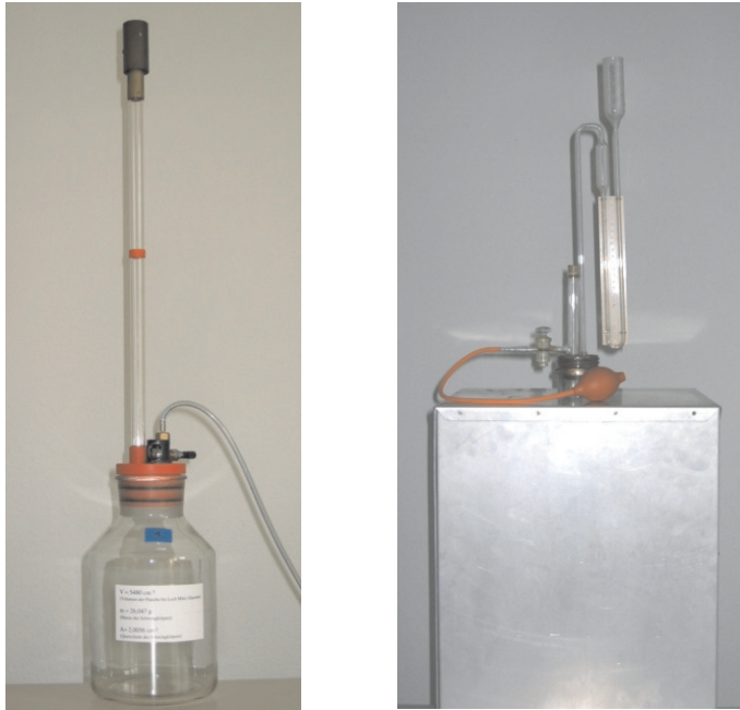
Abbildung 1: Links: Versuchsaufbau nach Rüchardt. Rechts: Aufbau nach Clément-Desormes. Der Gasbehälter befindet sich im Aluminiumgehäuse.
