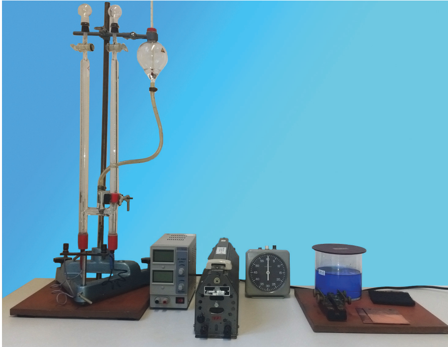
Abbildung 1: Übersicht des Versuchs Elektrolyse.
