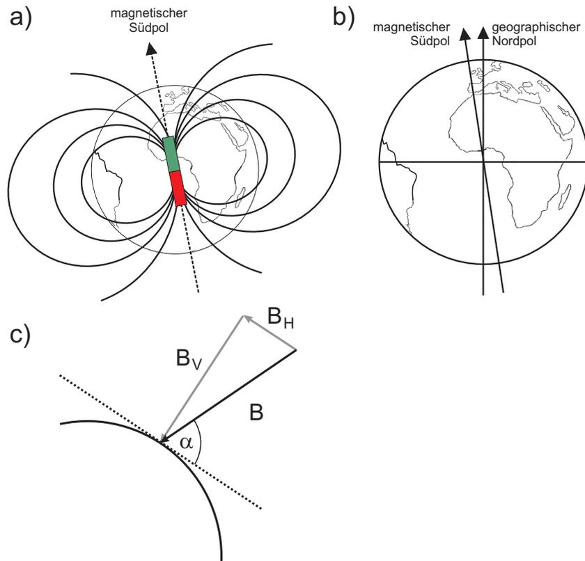
Abbildung 3: a) Schematischer Verlauf des Erdmagnetfelds. b) Die Abweichung von der Dipolachse und der Rotationsachse der Erde wird als Deklination bezeichnet und beträgt  $11,5^\circ$ . c) Zerlegung des  $B$ -Feldes in eine Horizontal und eine Vertikalkomponente. Die Inklination  $\alpha$  beträgt in Deutschland etwa  $66^\circ$ .
