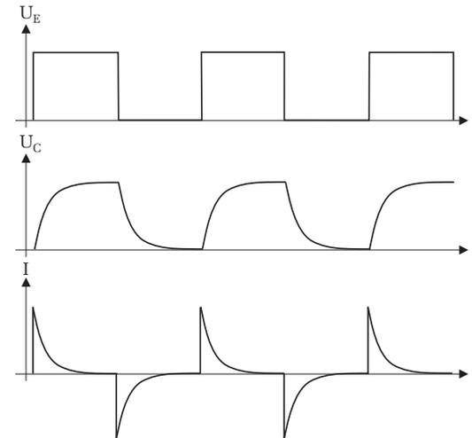
Abbildung 3: Eine rechteckförmige Eingangsspannung  $U_E$  bewirkt ein kontinuierliches Laden und Entladen des Kondensators. Beachten Sie, dass sich die Richtung des Ladestroms  $I$  beim Entladen umkehrt.
