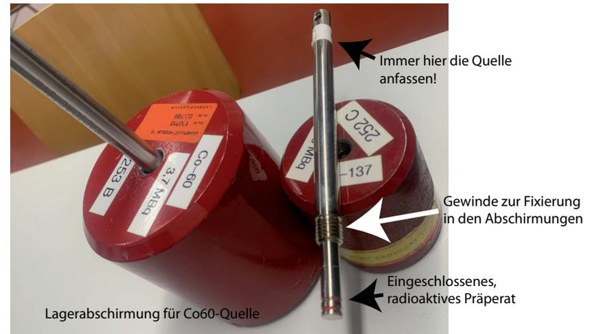
Abbildung 5: Die im Praktikum verwendeten Co-60- und Cs-137-Quellen
