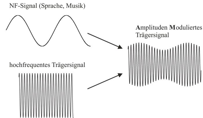
Abbildung 19: Prinzip der Amplitudenmodulation.
