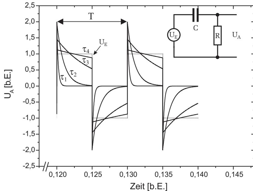
Abbildung 9: Spannungsverlauf  $U_A$  eines Differentiators (Hochpass) bei einer rechteckförmigen Eingangsspannung (gestrichelte Kurve) für verschiedene Zeitkonstanten  $\tau$ :  $\tau_1 = 0,02T$ ,  $\tau_2 = 0,1T$ ,  $\tau_3 = 0,5T$ ,  $\tau_4 = 2T$ .
