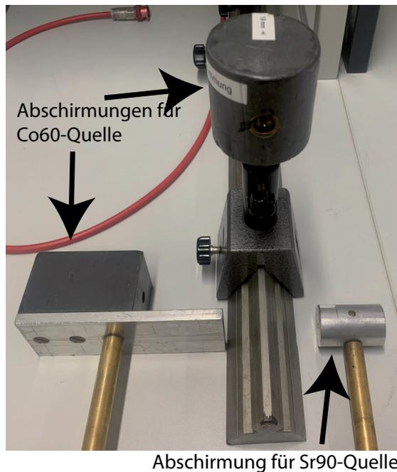
Abbildung 6: Verwendete Abschirmung für die Versuche 251 und 253
