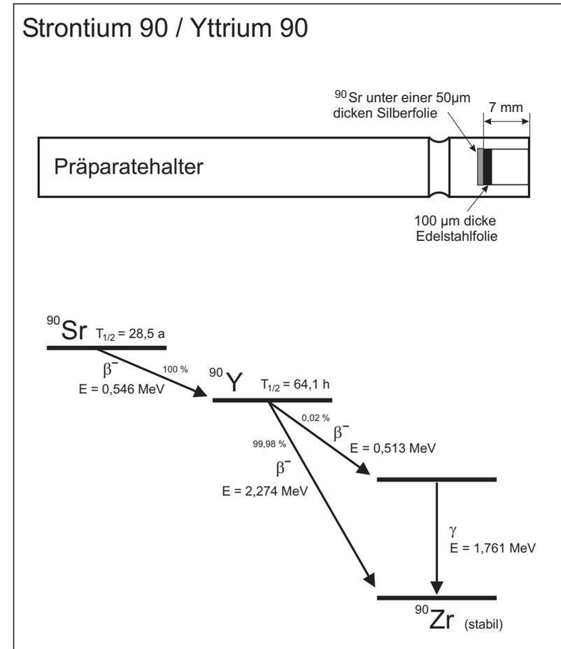
Abbildung 7: Oben: Aufbau des Strontium 90 Präparats. Unten: Zerfallschema von Strontium 90 / Yttrium 90. Angegeben sind die Halbwertszeiten  $T_{1/2}$ , die Zerfallsart ( $\beta, \gamma$ ), die Energie der emittierten Strahlung sowie die Übergangswahrscheinlichkeiten in Prozent.
