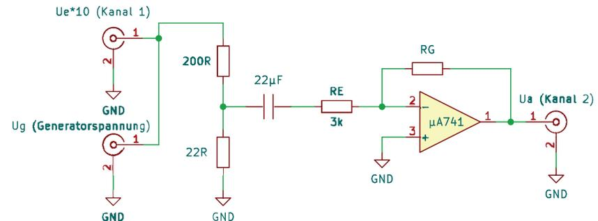
Abbildung 6: Schaltung Wechselspannungsverstärker
