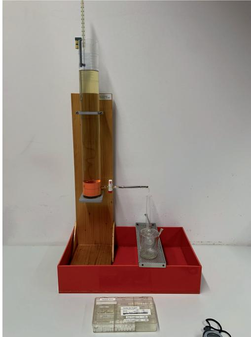
Abbildung 1: Kugelfallviskosimeter und Kapillarviskosimeter
