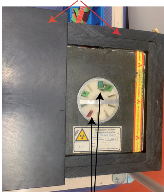
Metalpräparate in der Neutronenquelle zur Aktivierung
