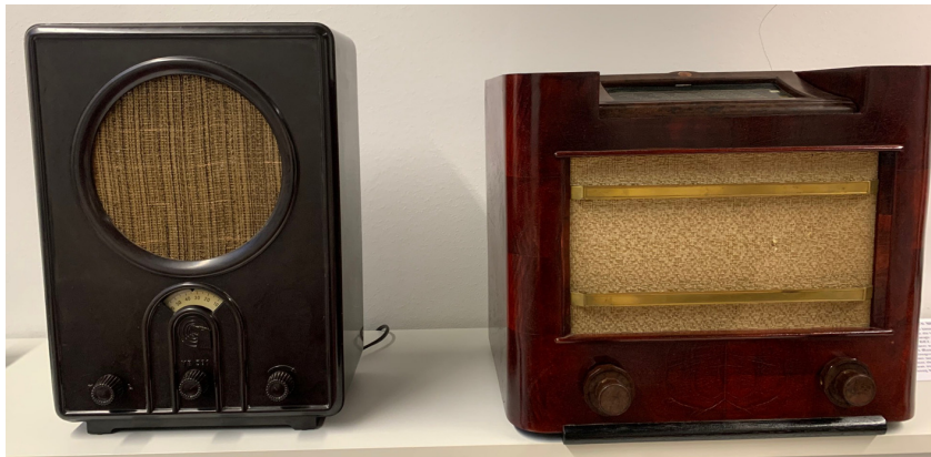
Abbildung 24: Audion und Superhet Radioempfänger aus den 1930er Jahren
