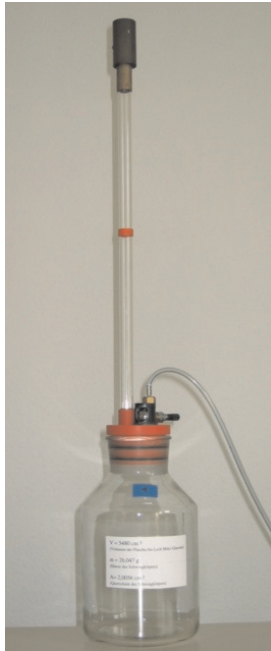
Abbildung 1: Links: Versuchsaufbau nach Rüchardt. Rechts: Aufbau nach Clément-Desormes. Der Gasbehälter befindet sich im Aluminiumgehäuse.
