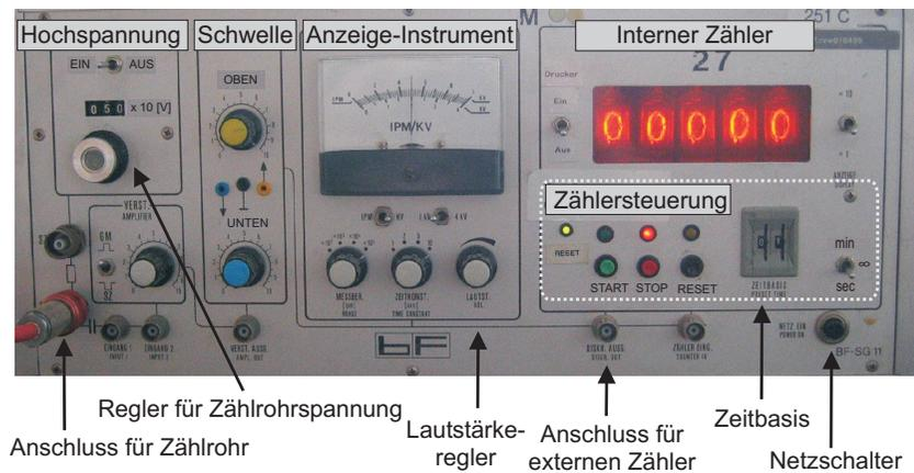
Abbildung 4: Frontplatte des Zählgerätes BF-SG 11
