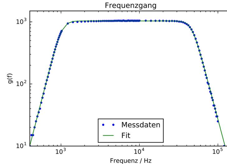
Abbildung 8: Frequenzgang mit eingeschränkten Start und Stopp Bereich.
