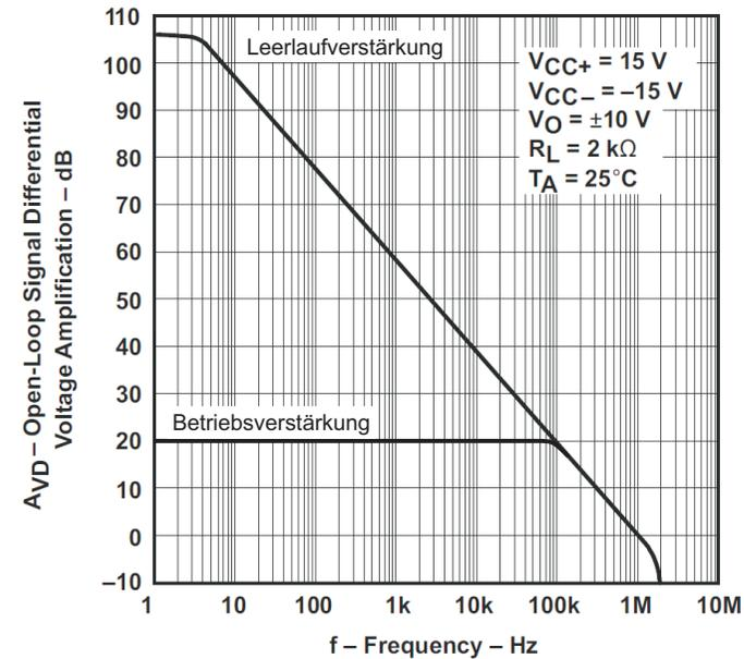
Abbildung 4: Frequenzgang der Betriebsverstärkung eines  $V' = 10$  Verstärkers, was in logarithmischer Darstellung 20 db entspricht. Quelle: Texas Instruments
