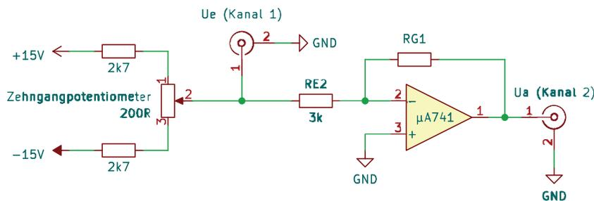
Abbildung 5: Schaltung Gleichspannungsverstärker
