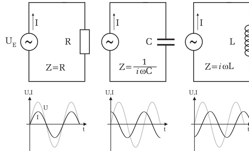
Abbildung 4: Impedanz von Widerstand, Kondensator und Spule
