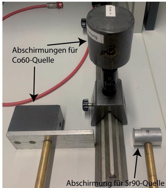
Abbildung 6: Verwendete Abschirmung für die Versuche 251 und 253
