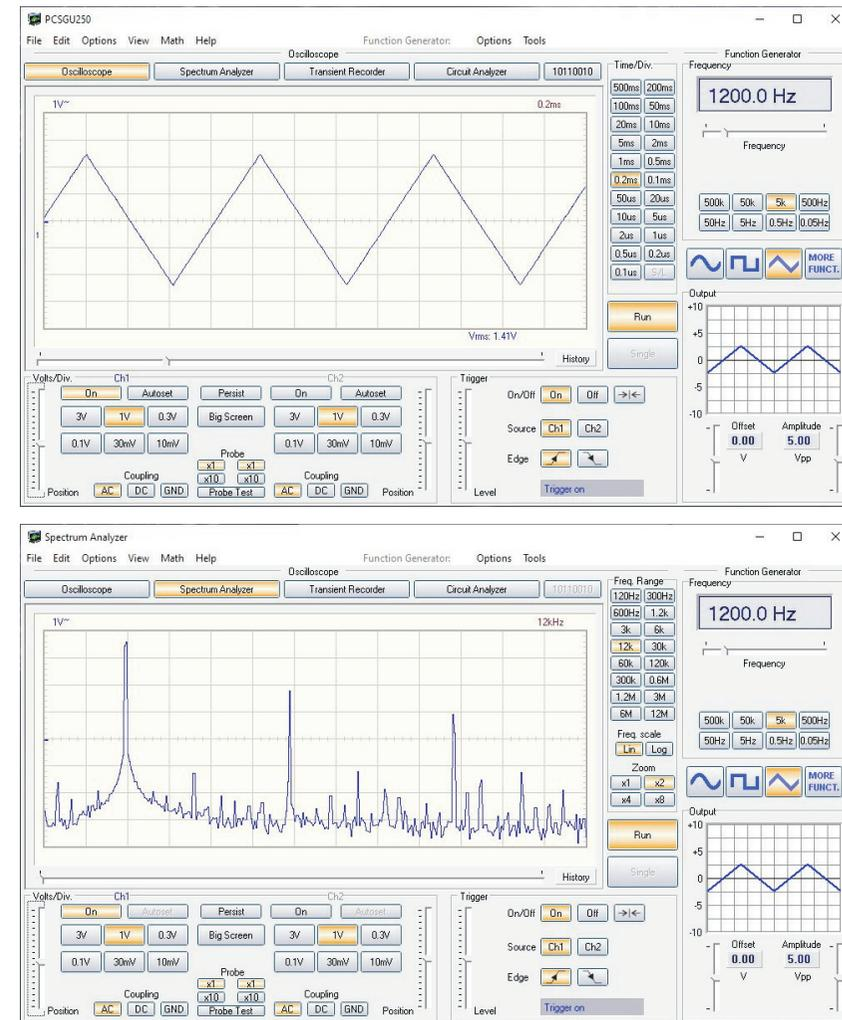
Abbildung 22: Oben: Zweikanal Speicheroszilloskop – Unten: Spektrumanalysator
