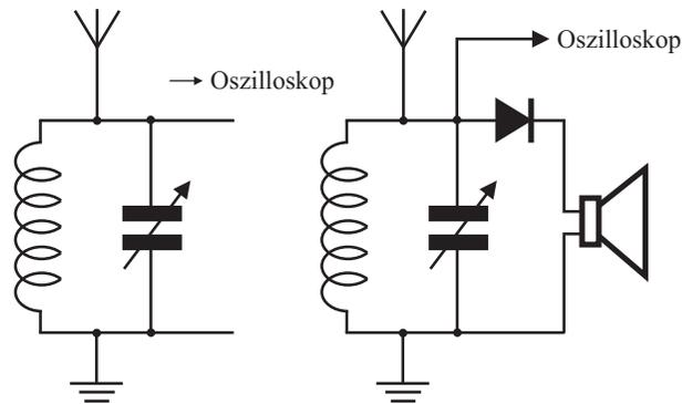
Abbildung 27: *Prinzip eines AM-Empfängers. Links: Empfangskreis – Rechts: Empfangskreis mit Demodulator-Diode*
