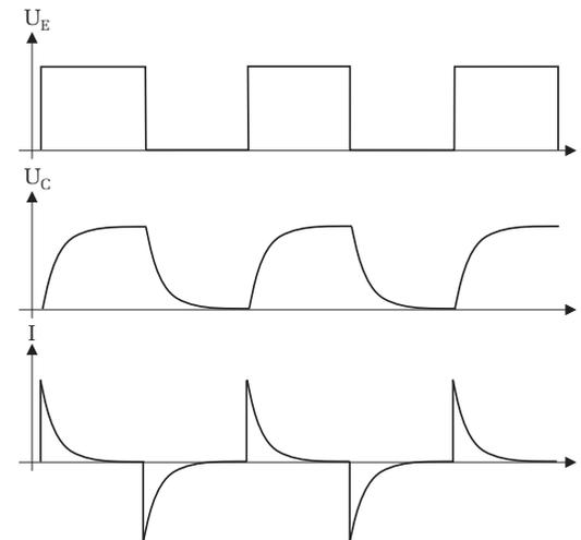
Abbildung 3: Eine rechteckförmige Eingangsspannung  $U_E$  bewirkt ein kontinuierliches Laden und Entladen des Kondensators. Beachten Sie, dass sich die Richtung des Ladestroms  $I$  beim Entladen umkehrt.
