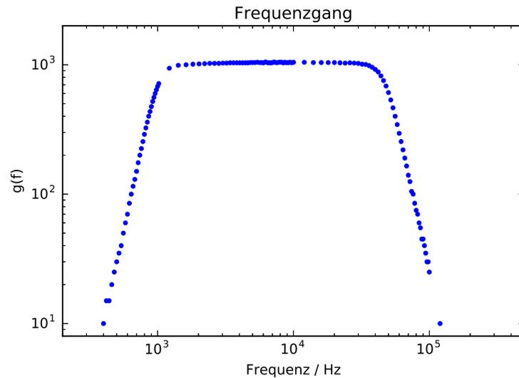
Abbildung 7: Frequenzgang mit eingeschränkten Start und Stopp Bereich
