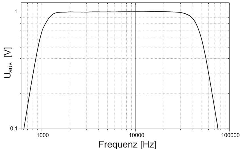
Abbildung 5: Frequenzgang des Verstärkers mit nachgeschaltetem Bandfilter.
