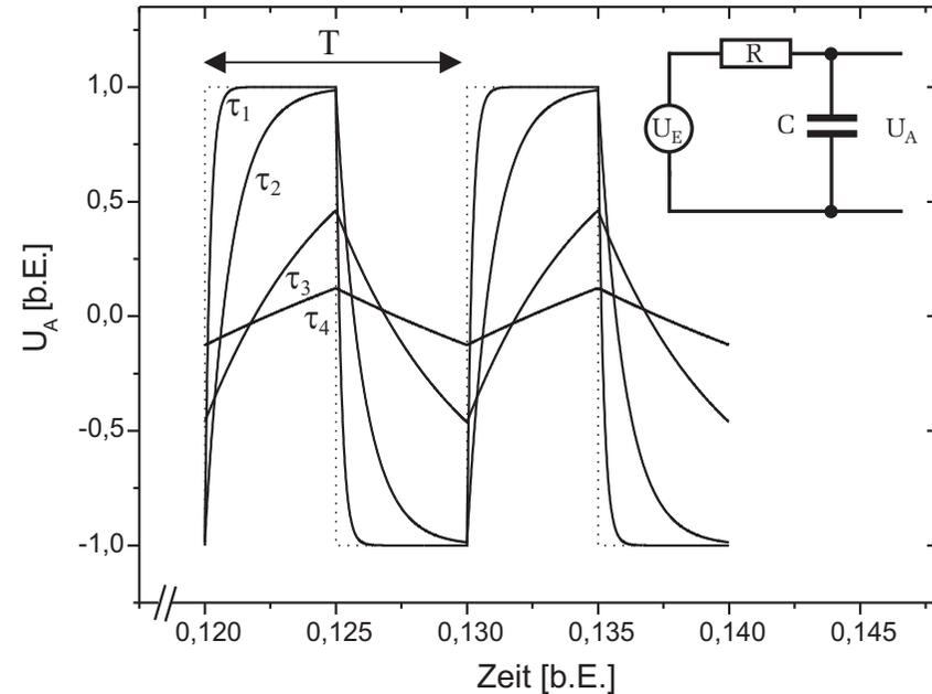
Abbildung 8: Spannungsverlauf  $U_A$  eines Integrators (Tiefpass) bei einer rechteckförmigen Eingangsspannung (gestrichelte Kurve) für verschiedene Zeitkonstanten  $\tau$ :  $\tau_1 = 0,02T$ ,  $\tau_2 = 0,5T$ ,  $\tau_3 = 1T$ ,  $\tau_4 = 2T$ .
