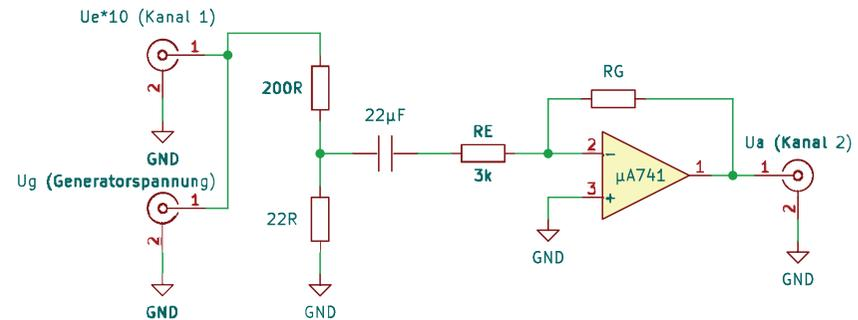
Abbildung 6: Schaltung Wechselspannungsverstärker
