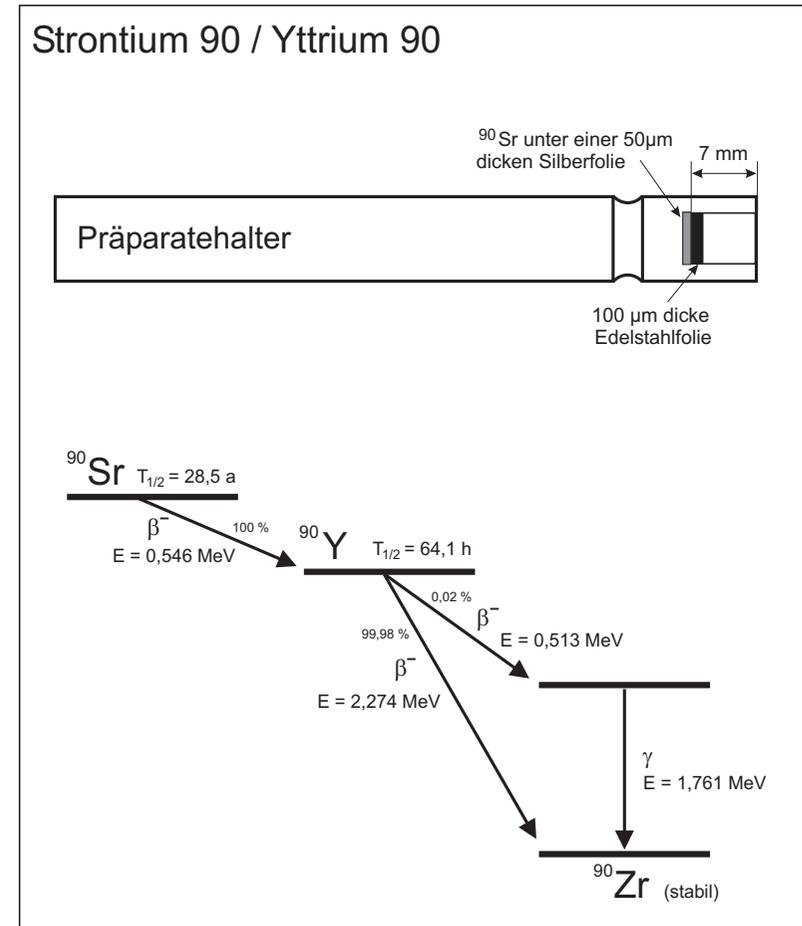
Abbildung 7: Oben: Aufbau des Strontium 90 Präparats. Unten: Zerfallschema von Strontium 90 / Yttrium 90. Angegeben sind die Halbwertszeiten  $T_{1/2}$ , die Zerfallssart ( $\beta, \gamma$ ), die Energie der emittierten Strahlung sowie die Übergangswahrscheinlichkeiten in Prozent.
