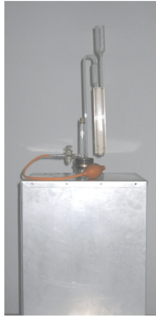
Abbildung 1: Links: Versuchsaufbau nach Rüchardt. Rechts: Aufbau nach Clément-Desormes. Der Gasbehälter befindet sich im Aluminiumgehäuse.
