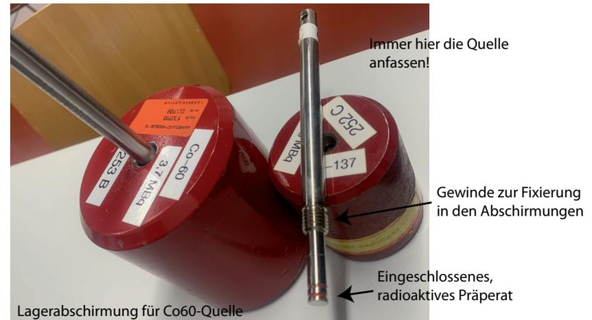
Abbildung 5: Die im Praktikum verwendeten Co-60- und Cs-137-Quellen
