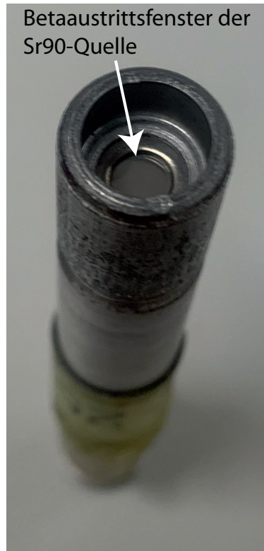
Abbildung 7: Das Betaaustrittsfenster der Sr_{90} -Quelle
