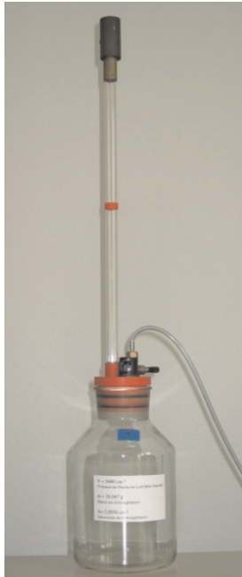
Abbildung 1: Links: Versuchsaufbau nach Rüchardt. Rechts: Aufbau nach Clément-Desormes. Der Gasbehälter befindet sich im Aluminiumgehäuse.
