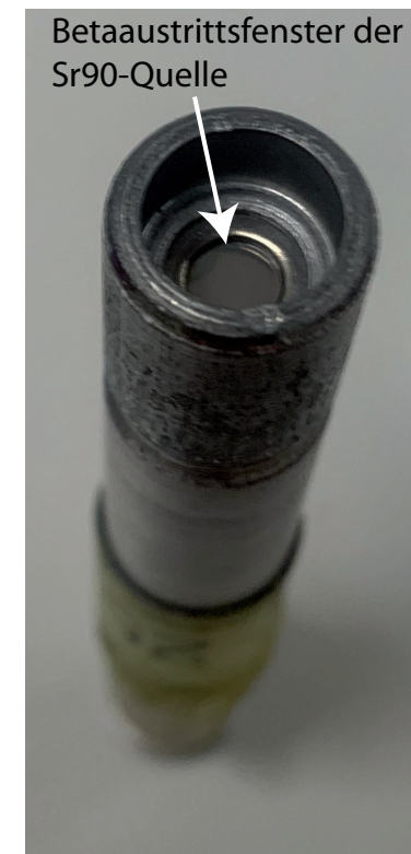
Abbildung 7: Das Betaaustrittsfenster der Sr 90 -Quelle
