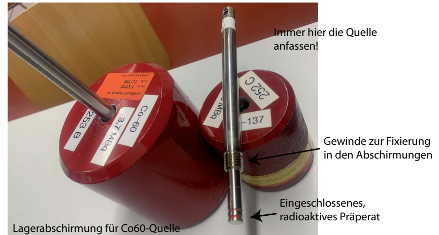
Abbildung 5: Die im Praktikum verwendeten Co-60- und Cs-137-Quellen
