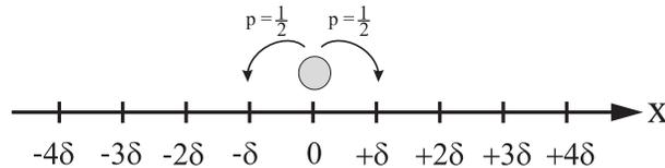
Abbildung 3: *Eindimensionaler Random-Walk. Bei jedem Stoß bewegt sich das Partikel mit der gleichen Wahrscheinlichkeit entweder nach links oder nach rechts. Die Sprungweite  $\delta$  soll bei allen Stößen gleich groß sein*
