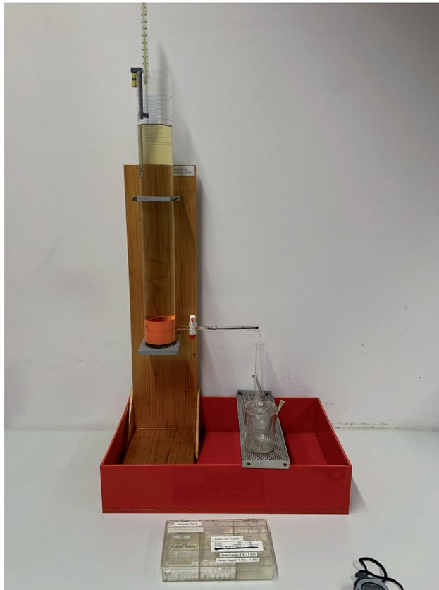
Abbildung 1: Kugelfallviskosimeter und Kapillarviskosimeter
