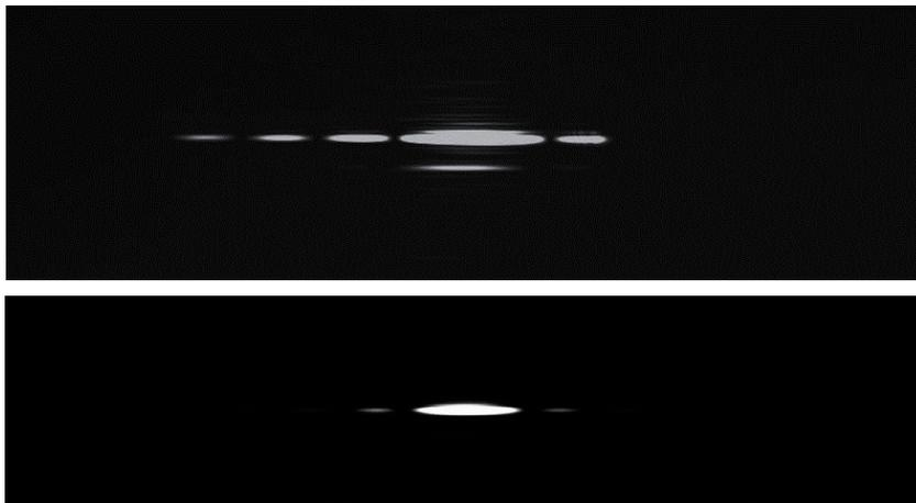
Abbildung 32: *Oben: Beugungsbild bei nicht mittig eingestelltem Analyserspalt*
