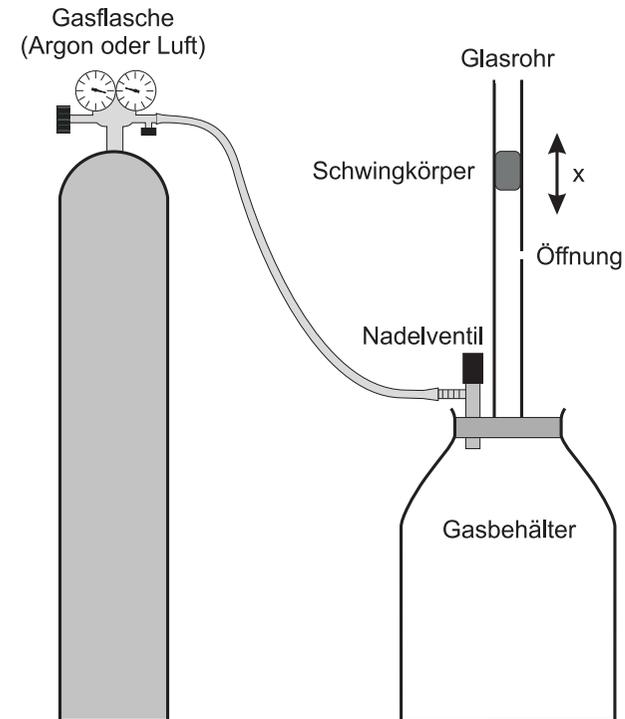
Abbildung 3: Versuchsaufbau nach Rüchardt.
