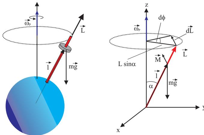
Abbildung 7: Links: Durch eine Zusatzmasse an der Figurenachse wird aus dem kräftefreien Kreisel ein schwerer Kreisel. Die Gewichtskraft übt ein äußeres Drehmoment  $\vec{M} = \vec{l} \times m\vec{g}$  aus, so dass der Kreisel mit der Frequenz  $\vec{\omega}_P$  um die z-Achse präzidiert. Rechts: Geometrie zur Bestimmung der Präzessionsfrequenz.
