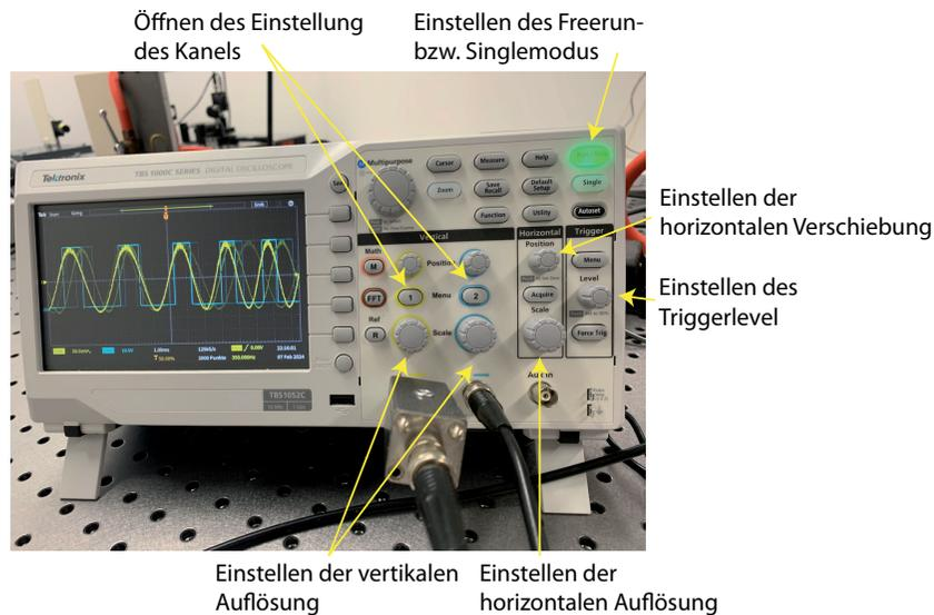
Abbildung 12: *Bedienelemente des Oszilloskops*
