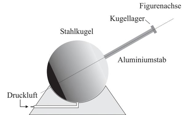
Abbildung 9: Aufbau des Luftkissenkreisels
