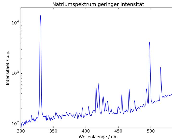
Abbildung 11: Natriumspektrum im Bereich 300 nm bis 540 nm
